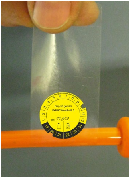
Abb. 7 Beispiel für eine Prüfbanderole zur Befestigung an der Leitung
